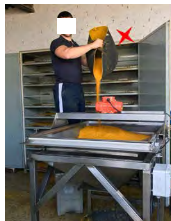
Tamizadora comercial, Gabriel Sánchez Secar Polen, para polen seco o fresco
