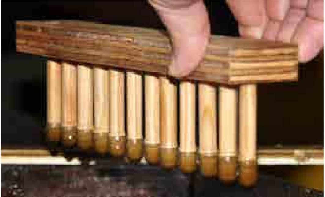
Artificio de madera para fabricar cúpulas con cera natural caliente
